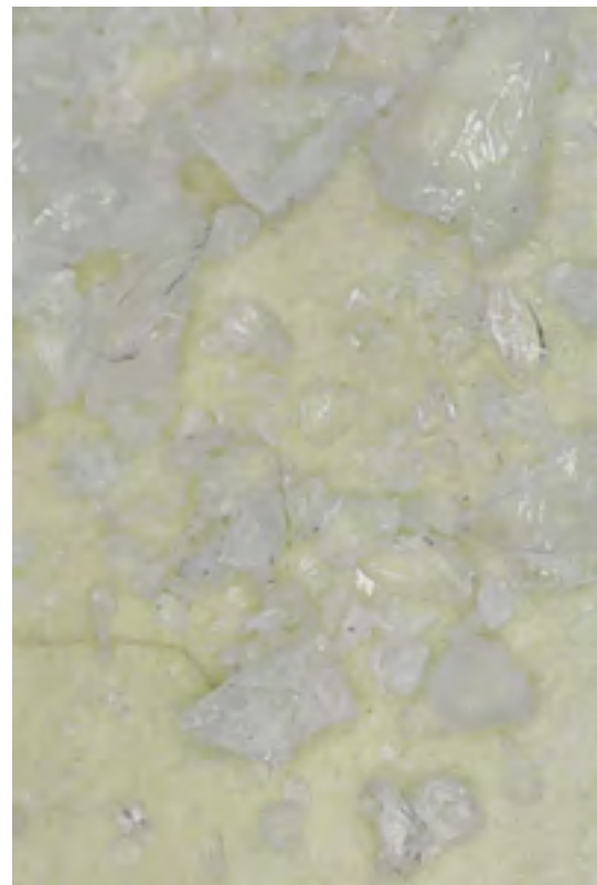
Imagen aumentada del polvo de trituración (arriba) y el polvo de vidrio (abajo), que evidencia la angularidad de las partículas.
