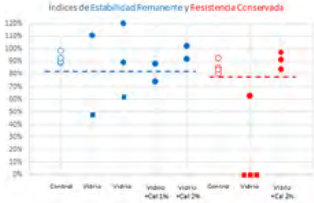
Gráfico 2. Resultados individuales de sensibilidad al agua y límites inferiores especificados para el promedio, 85% para el IER y 80% para el IRC.
